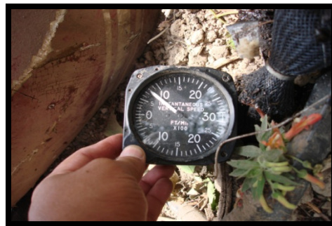
Fotografía No. 2 Velocidad de Ascenso
