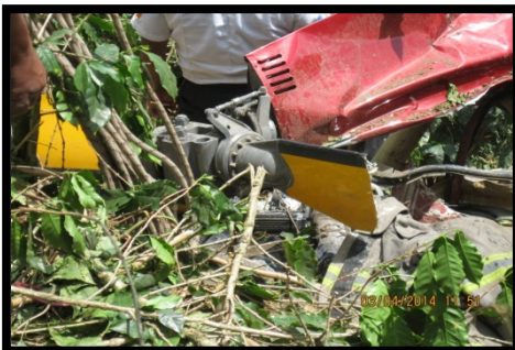
Fotografía No. 15 Vista de Daños al Rotor Principal
